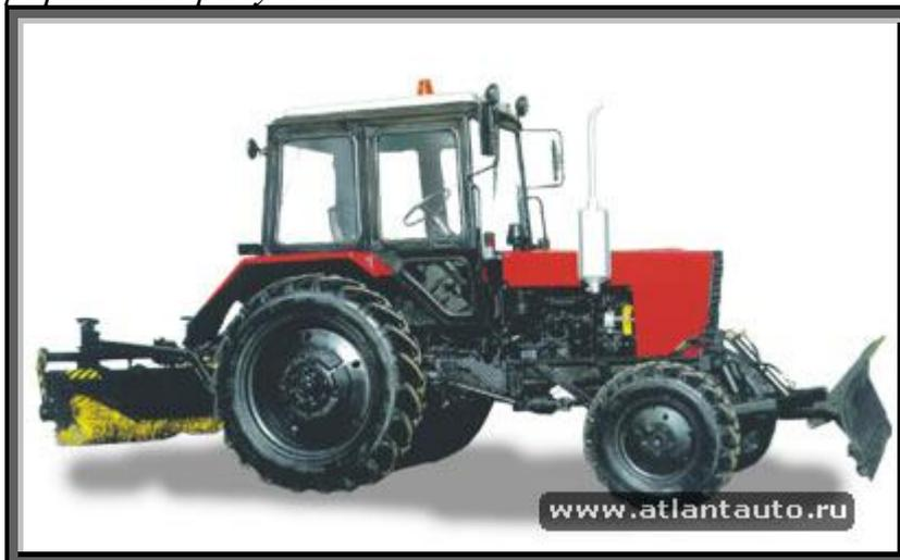
Рисунок 3.1. Общий вид плужно-щеточной машины
